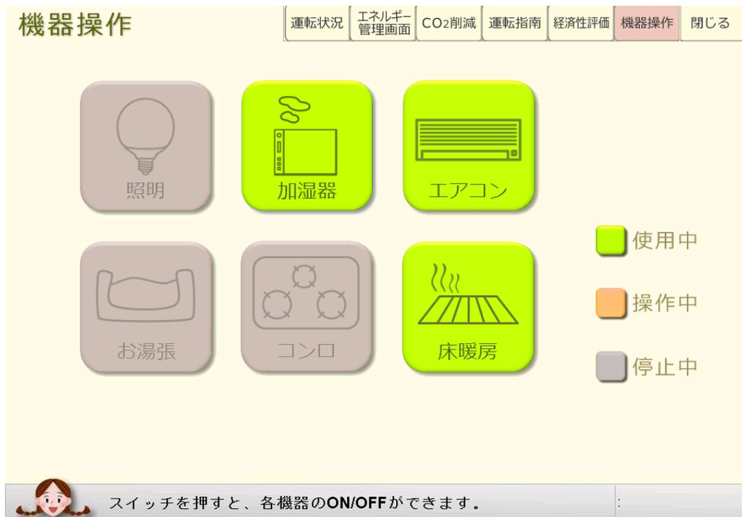
図 3-49 ホームサーバ (HS) の機器操作画面 (左 : 「照明」 OFF 完了)
