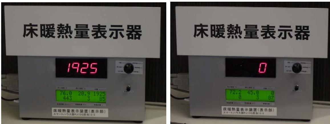
図 3-55 HS を介した機器操作・床暖房（温水流量「ml/分」、左:ON 時、右:OFF）
