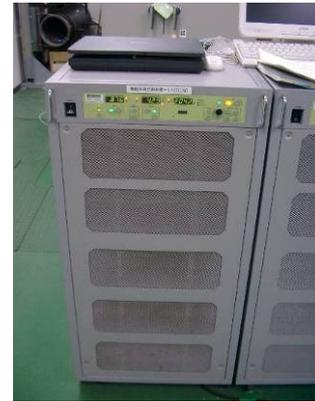
図 3-23 電力実験場・模擬負荷（電子負荷）
