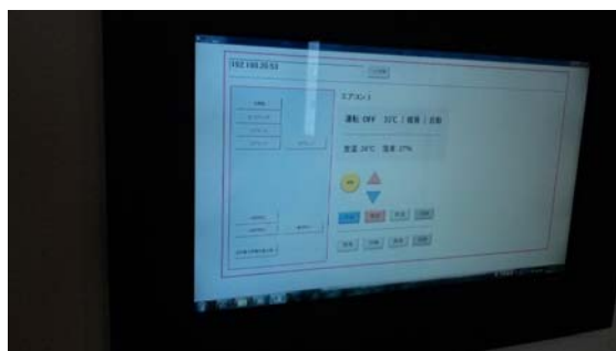
図 2-14 フォトフレーム(PC)による統合リモコン画面
