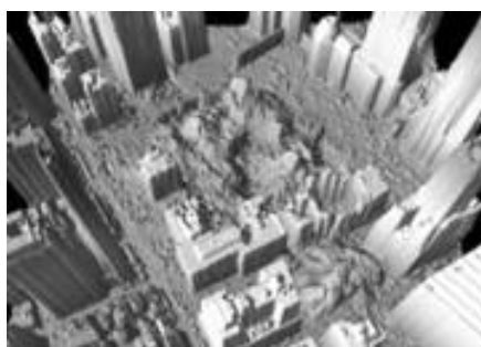
世界貿易センター(WTC)上空から南西に見た NOAA の空中レーザ広幅マッピング (airborne laser swath mapping: ALSM) イメージ
