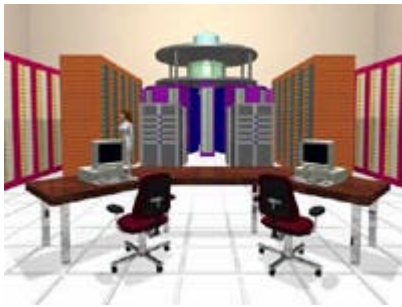
図：アーティストによる HTMT のアーキテクチャを採用したコンピューティング システムのプロトタイプ の 3-D 表現。DARPA、NASA、NSA の研究者たちがハイブリッド HTMT システムの構築の実現可能性を評価しています。それは一貫して毎秒 ( 10^{15} ) の浮動小数点演算(1 ペタフロップ)の速度の能力を持っています。
