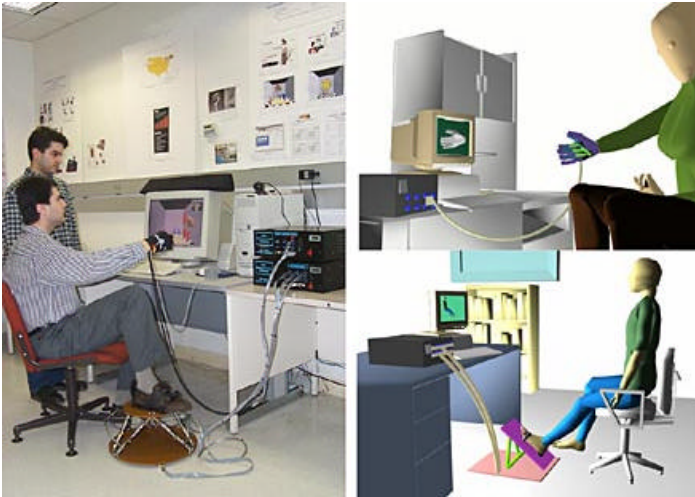
図： Rutgers 大学の「人間-コンピュータ・インターフェイス」の研究者は、ユニークなカフィードバック変換器を開発しました。これによって、外傷性の負傷から回復しつつある手足の段階的運動をコンピュータで制御したり監視したりすることができます。変換器は、手のグローブと足のブーツにぴったり合うように埋め込まれていて、きめられた持続時間、プログラムされた力と動きを負傷している手足に加えます。医療の専門家がリモートからコンピュータ・ネットワークを介してリハビリを監視します。そして、患者はコンピュータ化されたリハビリ運動のライブラリにアクセスができます。上の写真は、Rutgers 大学のカフィードバック・システムです。下の写真は、リモート・リハビリを行っている患者です。この研究は、NSF STIMULATE イニシアティブと障害者への対応(Aid to Persons with Disabilities)プログラムのもとでサポートされています。
