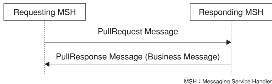
図1 Pull型メッセージングの原理
