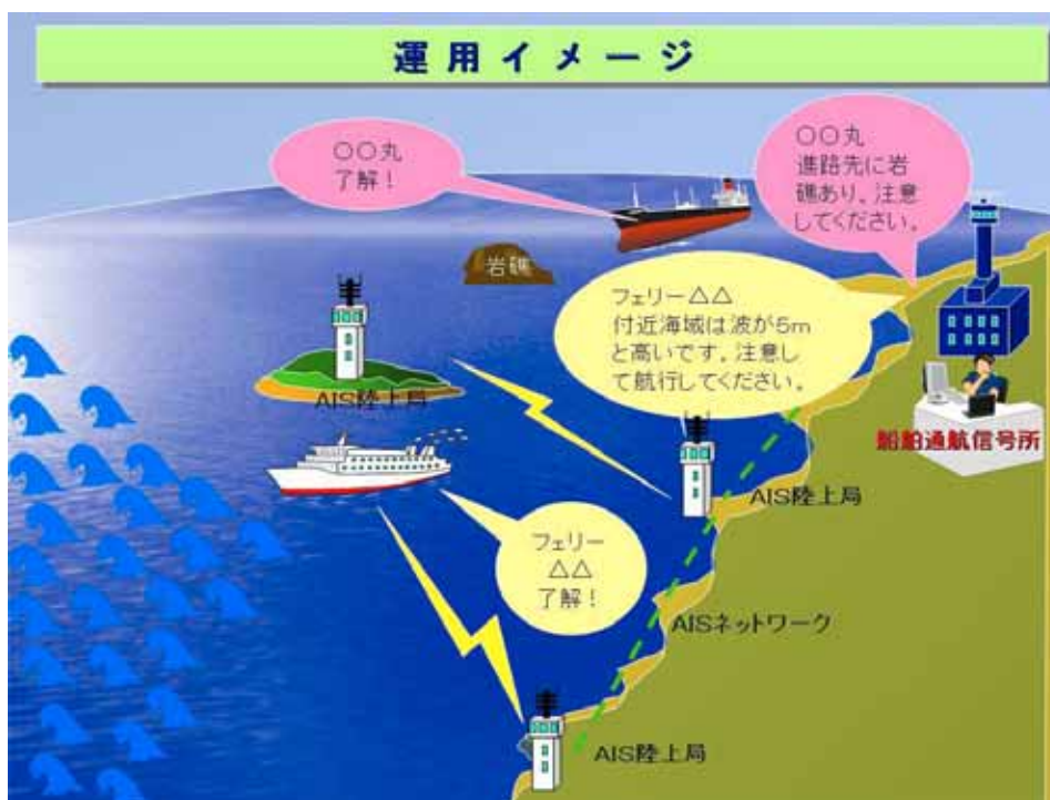
図 4-11 AIS 地上局、船舶通信信号所からの情報提供
