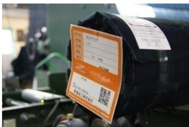
図 1.8 二次元コードと目視情報を印字した RFID ラベルタグを貼付
