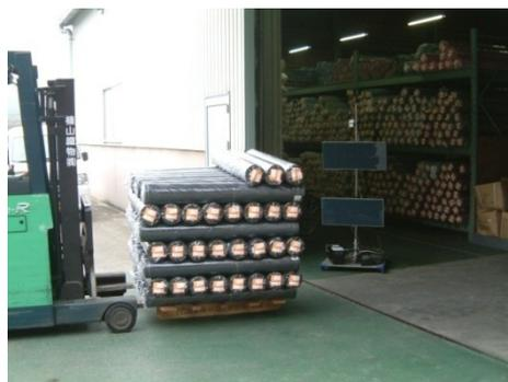
図 1.9 フォークリフトでパレットのままアンテナ前を通過し入荷検品
