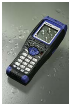
図 1-12 低出力 RFID ハンディーターミナル 出所：パナソニック システムソリューションズ社
