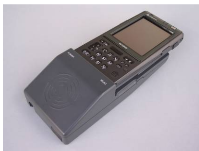
図 1-17 PDA 一体型 RFID リーダ 出所：三菱電機株式会社
