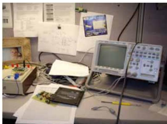
我々は、信号を解読するために従来のコンピュータに接続されたオシロスコープを用いて、RFID クレジットカードとリーダー間の通信を傍受している。
