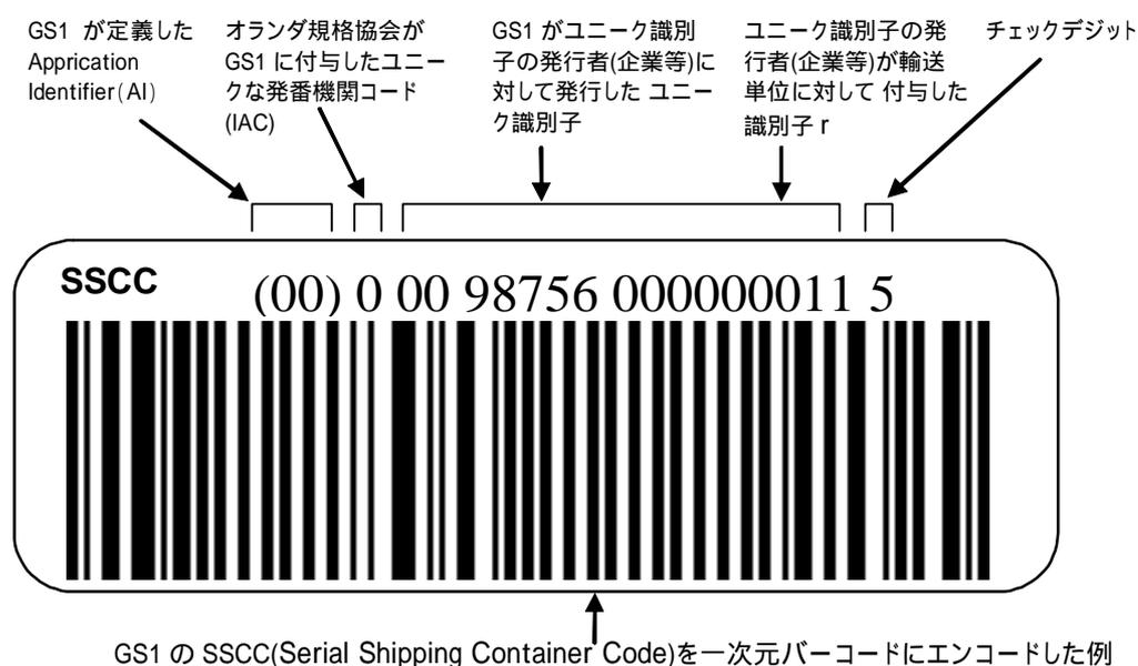
図 -3 ISO/IEC 15459 Part 1 で規定されたコードの例
