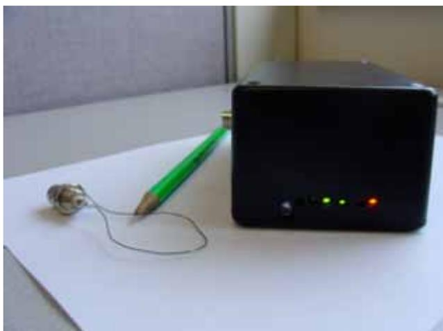
このプロトタイプのクローニング・デバイスは、そのアンテナを分離した状態で、大きさを比べるための鉛筆とともに示されている。
