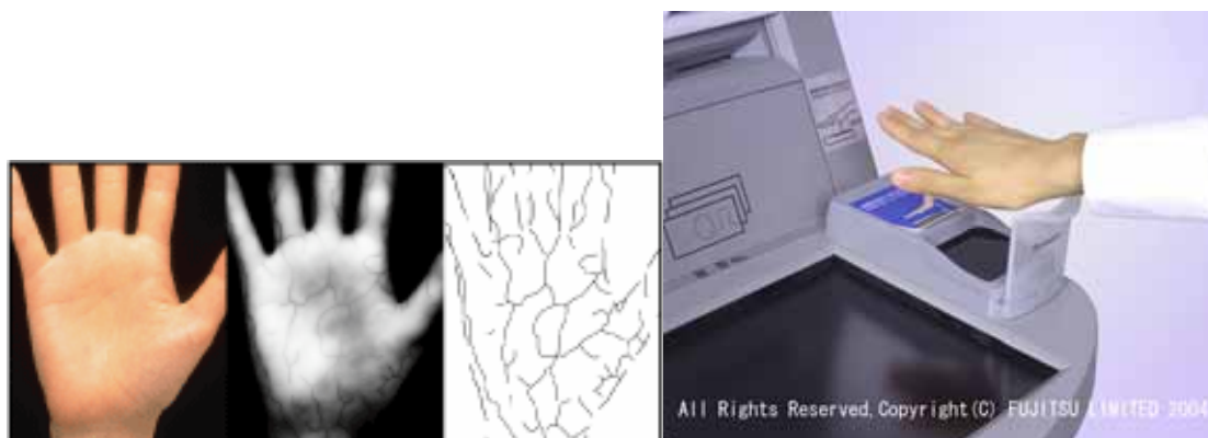
図 2-5 手のひら静脈認証のイメージ（上左）および、静脈認証装置に手をかざす様子（上右） （富士通株式会社ホームページ http://financial-systems.fujitsu.com/jp/services/pg/index.html より）
