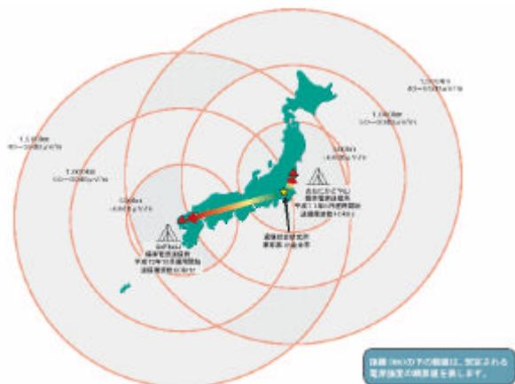
図1-3 長波標準電波送信所（福島局・九州局）の配置と、想定される電界強度計算値
