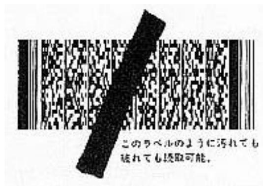
図 4-2 破損したコードの例
