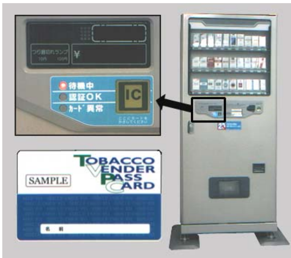
図 3-1 非接触 I C カードを利用した「成人識別機能付たばこ自販機」
