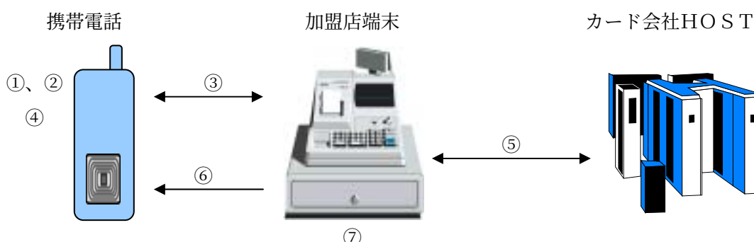
図 5-12 売上時の処理フロー（I C カードインフラ）
