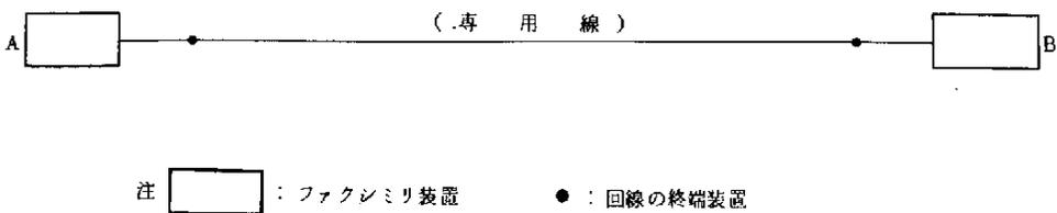
第2図 専用線によるファクシミリ通信の例
