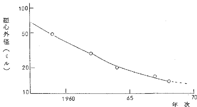
第2-11図 記憶磁心外径の小形化
