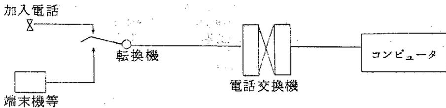
図-5 加入電話回線のデータ通信端末装置の接続
