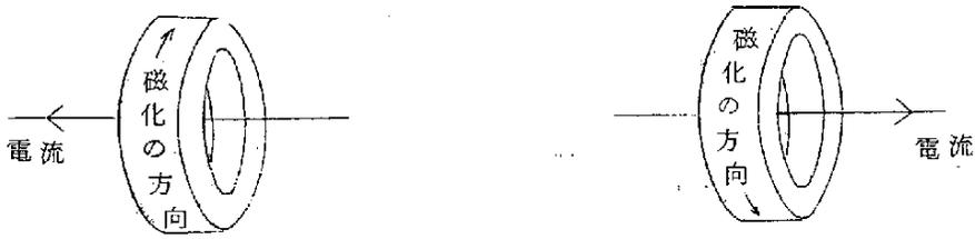
流れる方向によって、磁気コアは一定の方向に磁化される。また磁気コアに一定以上の逆の電流を流すと、磁化の方向は逆になる。磁気コアの状態を読みとるために、読取り線を磁気コアの中に入れておく。読取り線は、磁気コアの磁化の方向が変わった時に、電流が流れる。この読取り線に、電流が流れるか、流れないかによって、磁気コアが、0の状態であるか、1の状態であることを知ることができる。つまり、2つの磁化の方向の状態を、2進数の0と1に対応させているのである。したがって、磁気コア1個で、1ビットの情報を表現することができる。
