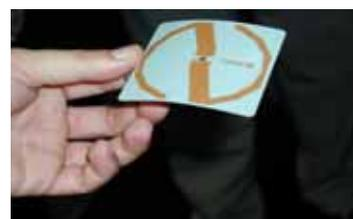
図 調査 2-1 各種形状のUHF帯電子タグ
