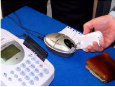
磁気ストライプカード用決済端末機の磁気リーダー部に「カードリーダーインタフェースカード」を差し込むことにより、既存の端末及びネットワークインフラがそのまま使用できるように工夫されている。既に一部店舗での実用化が始まっている。
