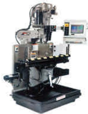
図 2-42 ブリッジポートV3XTミリングマシン
